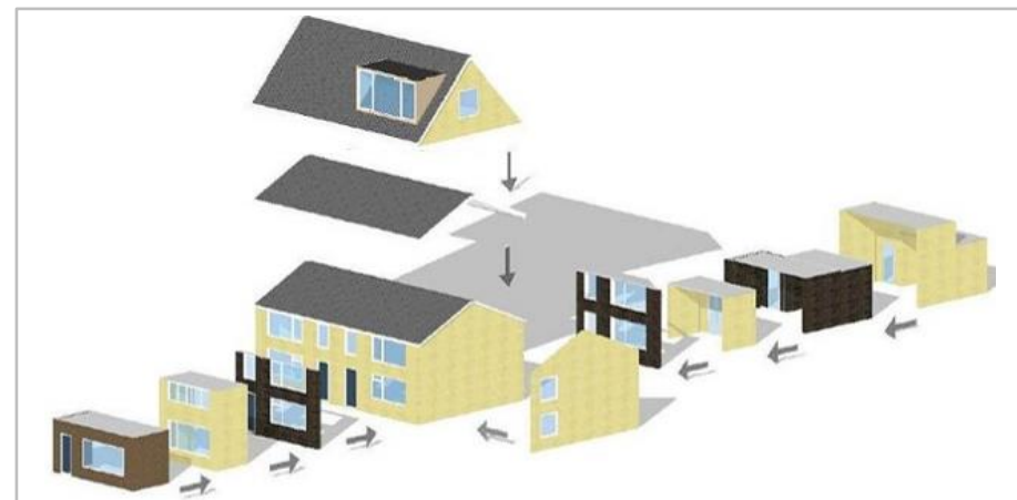
PREFAB-HSB-BOUWELEMENTEN WORDEN 2D EN 3D GEPREFABRICEERD EN GEMONTEERD
